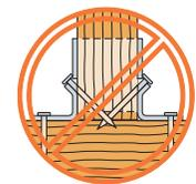
Les vis ne peuvent PAS remplacer les clous dans les connecteurs!
