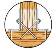
Le clouage à double cisaillement doit être fait avec des clous de longueur standard
